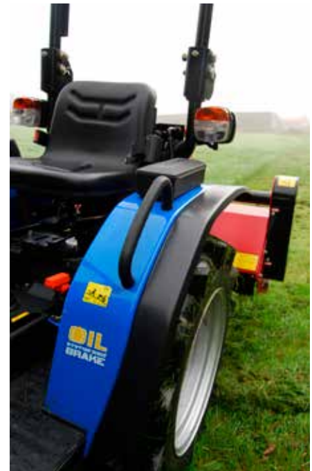
De spatborden zijn gemaakt uit plaatstaal en kunnen dus tegen een stootje.
