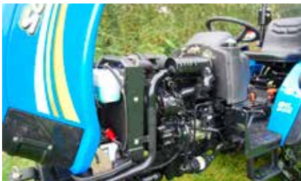
De volledige motorkap kantelt naar boven voor onderhoudswerkzaamheden.
